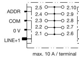
Typ: PM12-T02-00-LOAD-20A Potentialverteiler – LOAD
