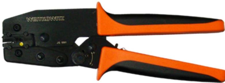
Presszange zum Verarbeiten von isolierten und nichtisolierten Quetschkabelschuhen, Verbindern und isolierten Flachsteckhülsen. Die entriegelbare Zwangssperre garantiert eine gleichbleibend hohe Pressqualität.
