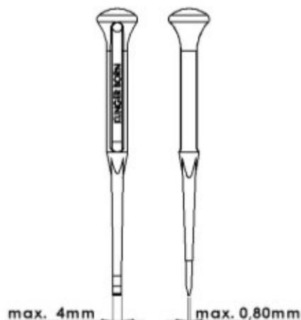
3) Verwenden Sie einen Schraubendreher mit einer Klinge von max. 4x0,8mm
