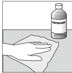
1. Die Oberflächen müssen trocken, frei von Staub, Öl, Oxiden, Trennmitteln und anderen Verunreinigungen sein. Die zu verklebende Oberfläche ist mit einem sauberen Tuch und Isopropanol / Wasser (50/50) zu reinigen. Bei Verwendung anderer geeigneter Reinigungsmittel ist darauf zu achten, dass die Oberfläche nicht angegriffen wird und keine Rückstände hinterlassen werden.
