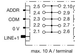
**Typ: PM12-T02-00-LOAD-20A Potentialverteiler – LOAD (2 x 5-fach, je 1 x Einspeisung, je 4 x LOAD)**
