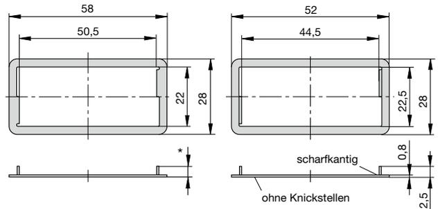
\* Y 303 675 01 ist nur verwendbar für Einbauwand-Dicke < 2 mm
