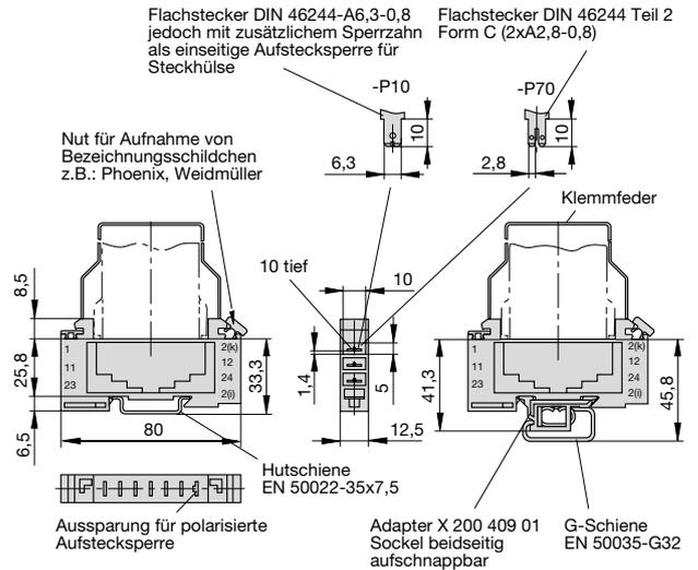
**Verbindungsschiene 50 A, 6-polig, für Stecksockel 17-P10-Si**
