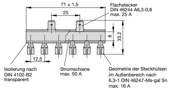
**Verbindungsschiene 10-polig (Lieferung als Set), für Stecksockel 17**
