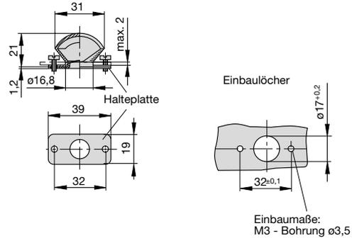
**Schutzkappe transparent mit Halteplatte und Befestigungsschrauben (IP54) für Typ 2210-S221-... (2-polig) und Typ 2210-S231-... (3-polig)**
