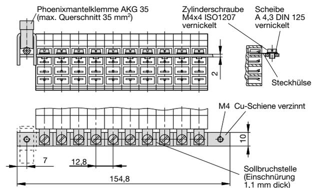
**Abdeckung für Verbindungsschiene (10-polig)**
