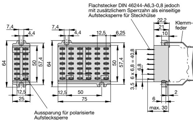
**Verbindungsschiene 50 A, 6-polig, für Klemmbretter 63-P10-Si**
