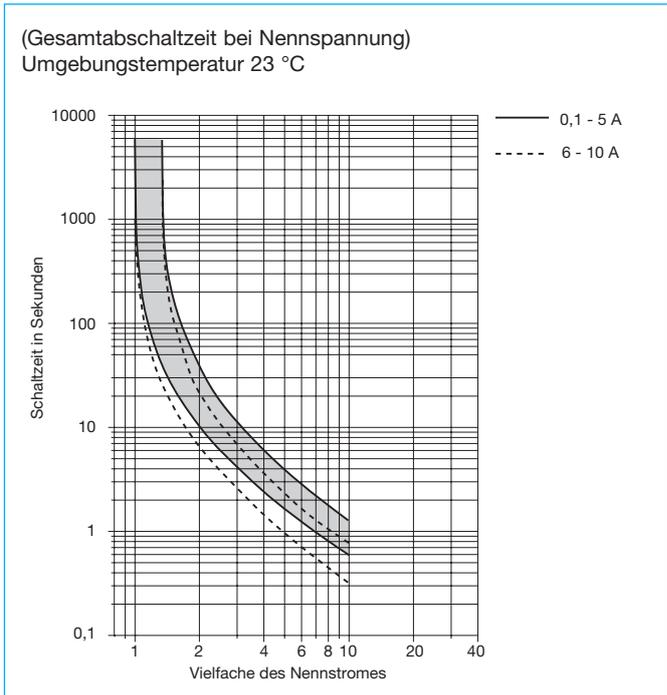
Die Zeit/Strom-Kennlinien sind abhängig von den Umgebungstemperaturen. Um eine vorzeitige oder späte Abschaltung zu vermeiden, muss der Schutzschalterennstrom mit einem Temperaturfaktor multipliziert werden (siehe auch Kapitel Technische Informationen).
