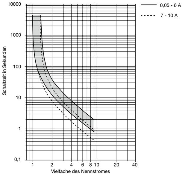
Die Zeit/Strom-Kennlinie ist abhängig von den Umgebungstemperaturen. Um eine vorzeitige oder späte Abschaltung zu vermeiden, muss der Schutzschalterennennstrom mit einem Temperaturfaktor multipliziert werden (siehe auch Kapitel Technische Informationen).
