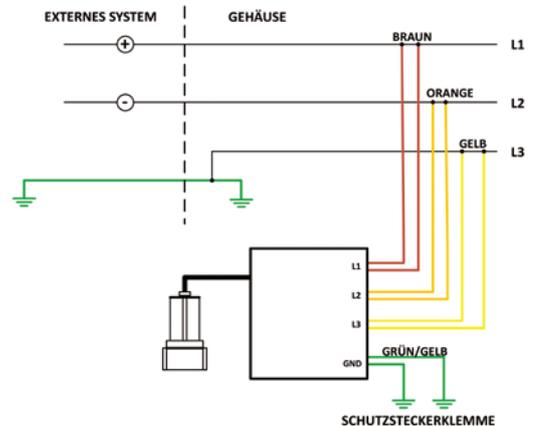
**⚠️ Warnung:** Der AVT muss ordnungsgemäß installiert und geerdet sein, wie in den Installationsanleitungen beschrieben, damit das Fehlen von Spannung korrekt angezeigt werden kann. Sensorleitungen, einschließlich der Masseleitung, dürfen nicht mechanisch miteinander verbunden werden, damit das Gerät die Verbindung zum Stromkreis überprüfen kann.
