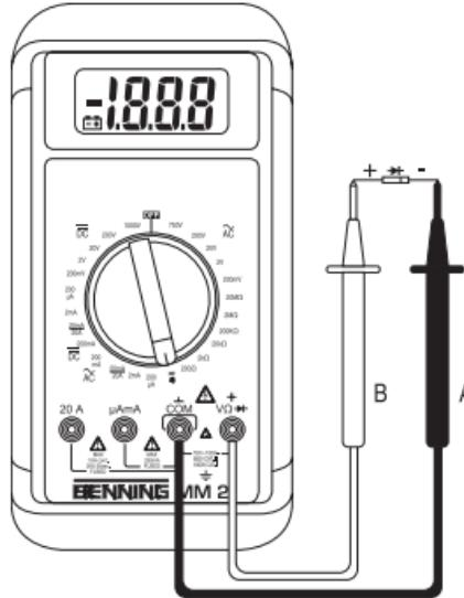
Bild 7: Diodenprüfung
