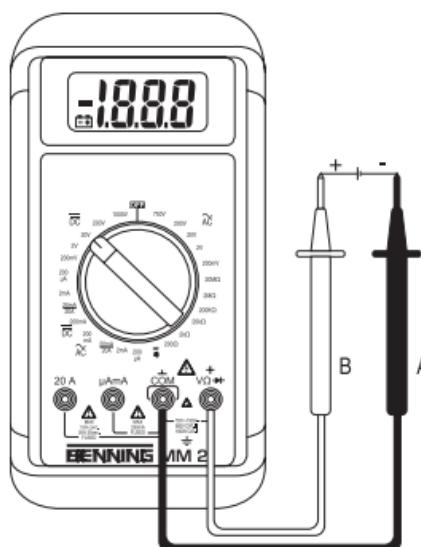
Bild 2: Gleichspannungsmessung
