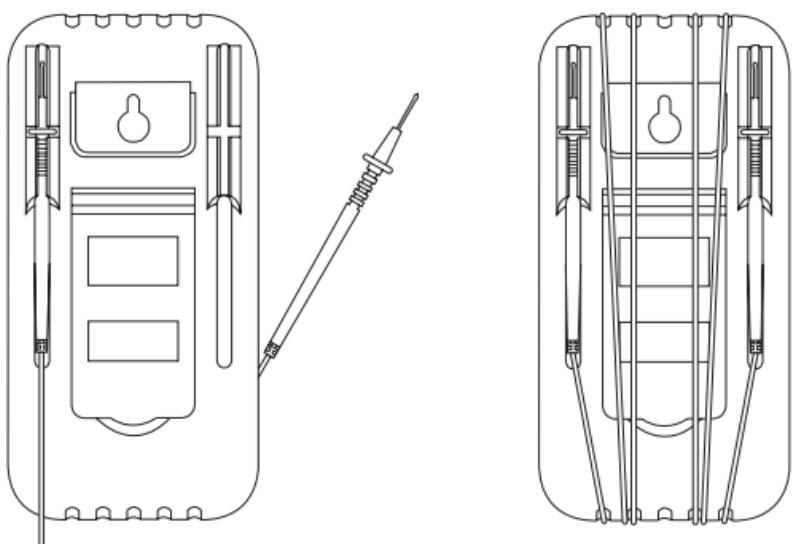
Bild 11: Aufwicklung der Sicherheitsmessleitung
