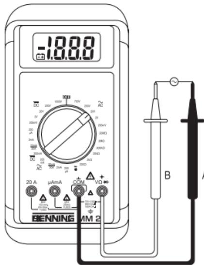
Bild 3: Wechselspannungsmessung
