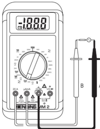
Bild 5: Wechselstrommessung
