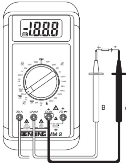
Bild 4: Gleichstrommessung
