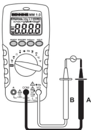
Bild 3: Wechselspannungsmessung
