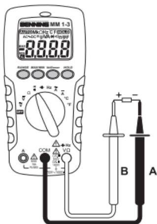
Bild 8: Durchgangsprüfung mit Summer
