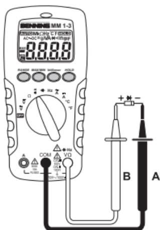
Bild 7: Diodenprüfung
