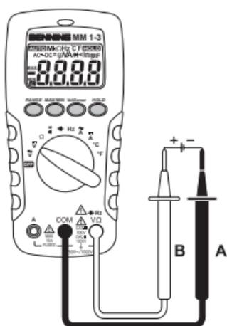
Bild 2: Gleichspannungsmessung
