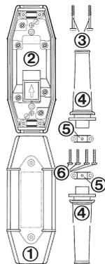
Der Wasserschutz hängt von der korrekten Montage ab. Anzugskraft für die Gehäuse-Schrauben ⓐ = 1 Nm.
