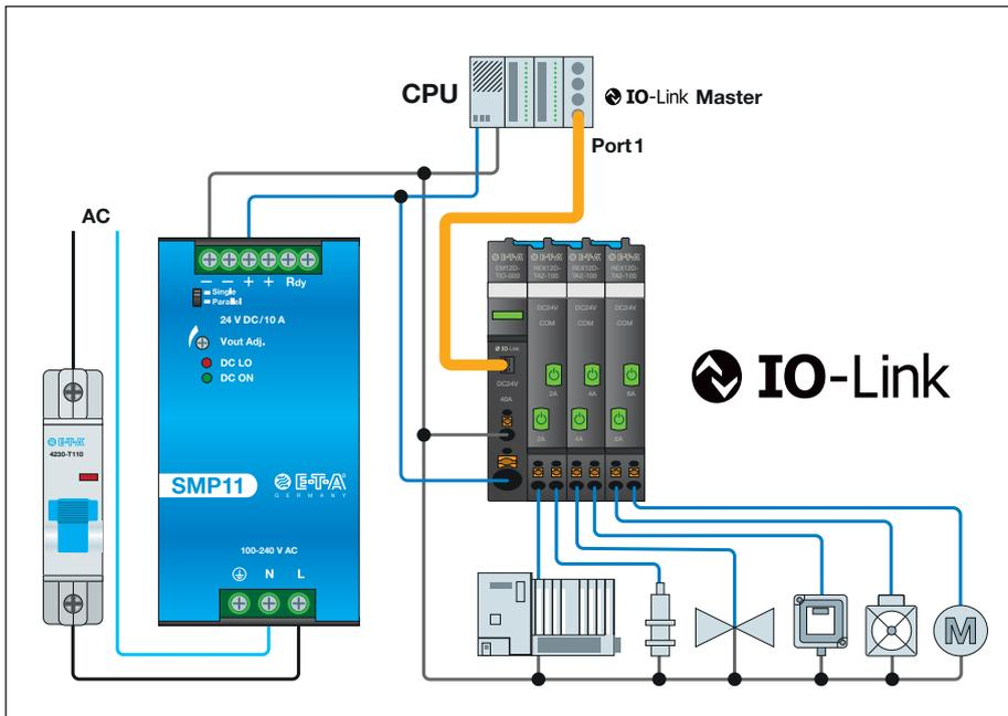
Bis zu 16 Kanäle des kommunikativen Sicherungsautomaten **REX12D-T** lassen sich über das Einspeisemodul **EM12D-T** an einem Port des übergeordneten **IO-Link Master** anbinden. Diese spezifizierte
