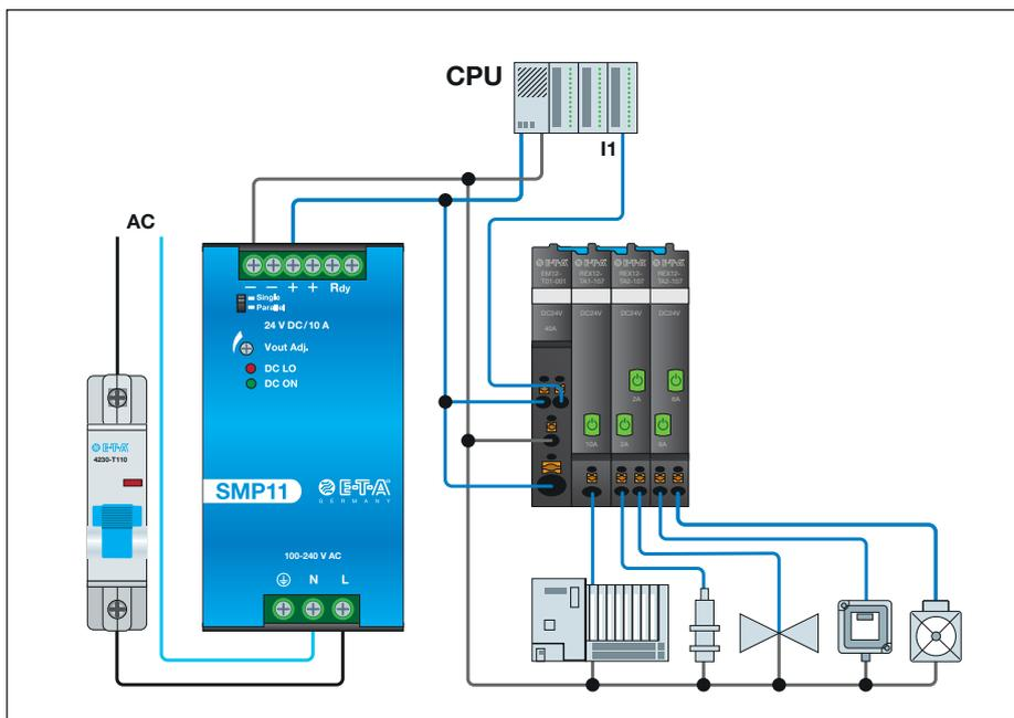
Die einkanaligen Sicherungsautomaten sind in allen gängigen Nennstromstärken von 1 A bis 10 A erhältlich. Die zweikanaligen Geräte sind in den Nennstromstärken 2 A, 4 A und 6 A verfügbar. Dies hilft, nicht nur leistungsstarke Verbraucher, sondern auch empfindliche Lasten und kleinste Leitungsquerschnitte abzusichern.
