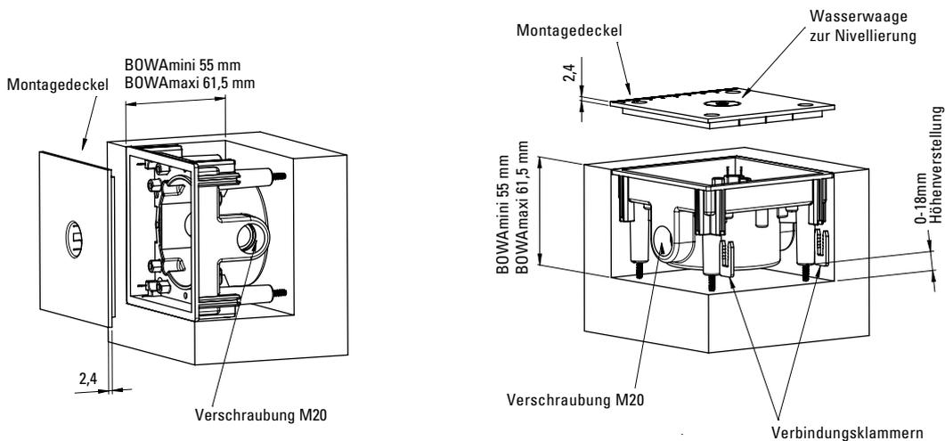
In das Leergehäuse 1632500 können alle nationalen und internationalen Unterputz-Systeme mit 80 mm Abdeckung und Tragringsbefestigung aus der Installations- und Kommunikationstechnik eingebaut werden.
