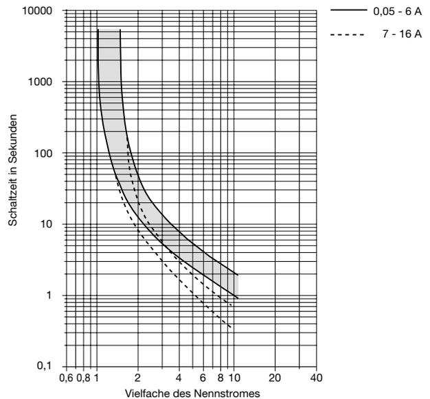
Die Zeit/Strom-Kennlinie ist abhängig von den Umgebungstemperaturen. Um eine vorzeitige oder späte Abschaltung zu vermeiden, muss der Schutzschalter-nennstrom mit einem Temperaturfaktor multipliziert werden (siehe auch Kapitel Technische Informationen).
